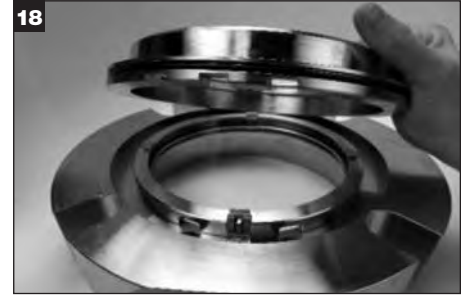
Adaptörü salmastra bileziğinden çıkarın. Adaptör O-Ringini (Z) çıkarın ve atın. Adaptörü bir kenara koyun.
